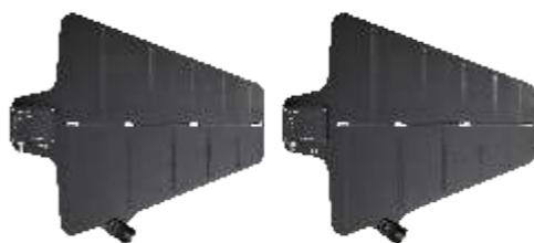
定向天线采用对数周期极偶振子阵列，能够在面向所需的覆盖区域提供最佳的接收效果，集成式放大器设有两档增益开关，用于补偿不同级别的同轴电缆信号损失。可将定向天线固定在支架上或可将其悬挂在天花板上，或者使用集成式可旋转支架固定在墙壁上。
