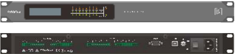
**Table<sup>+</sup> M8x8**是一款8进8出的自动混音矩阵，配备8路模拟输入和8路模拟输出，4路Dante输入和4路Dante输出。麦克风输入和线路输入自由切换，每路输入带48V幻象电源选择。内置反馈抑制、自动混音、矩阵混音、均衡器、分配器、压缩器等DSP功能。内置摄像跟踪功能。通过网络连接电脑软件控制，或RS232连接中控远程控制。适用场合：会议室、多功能厅、礼堂、法庭、专业演出等。
